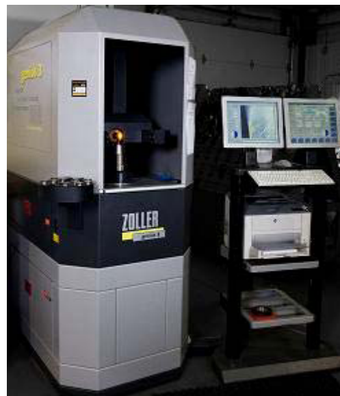
ZOLLER Genius 3 S ユニバーサル工具検査器
