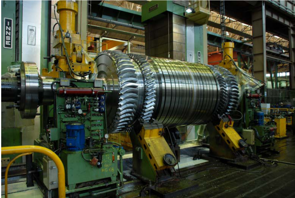
図4 機械加工後のガスタービンシャフト
