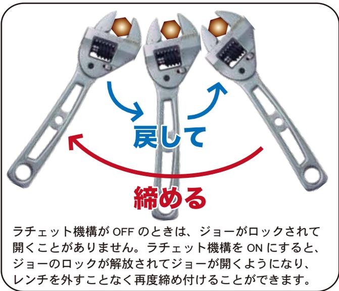
ラチェット機構が OFF のときは、ジョーがロックされて開くことがありません。ラチェット機構を ON にすると、ジョーのロックが解放されてジョーが開くようになり、レンチを外すことなく再度締め付けることができます。
