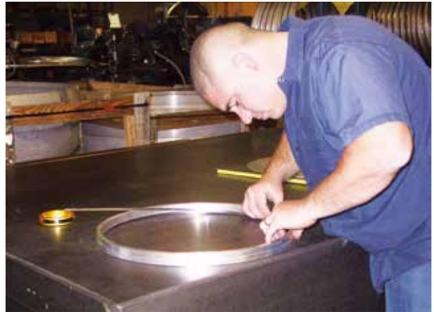
スチール製外径用パイテープでワークの外径を測定
