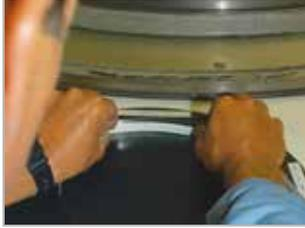
内径測定用パイテープは被測定物の内側にテープを沿わせて内径をはかるものです。0.01mm単位で読み取りが可能で、直径3600mmまでは±0.03mmの精度となります。内径測定用パイテープはテンションが0kgで製作されています。測定時もテンションがかからないように測定してください。
