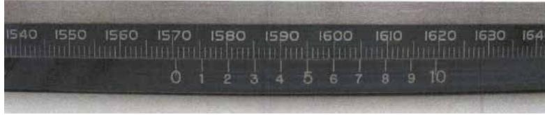
本尺の最小目盛は1.0mm、バーニアの最小目盛は0.1mmを表しています。テープをワークの外周に巻くと下図のように本尺目盛とバーニア目盛が上と下になります。これをノギスの目盛りを読むのと同じ要領で読み取ります。
