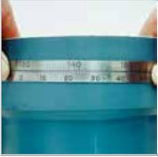
外径測定用パイテープは被測定物の外周にテープを巻きつけて外径をはかるものです。0.01mm単位で読み取りが可能で、直径3600mmまでは±0.03mmの精度となります。外径測定用パイテープはテンションが2.25kgで製作されています。測定時もテンションが2.25kgになるように測定してください。
