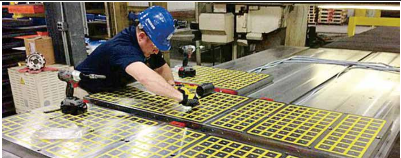
ダブルコラムマシニングセンターによる大型ワークの加工に使用
