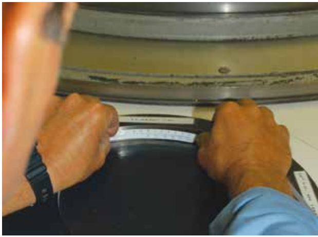
テンショナーを使って正確に外径を測定
