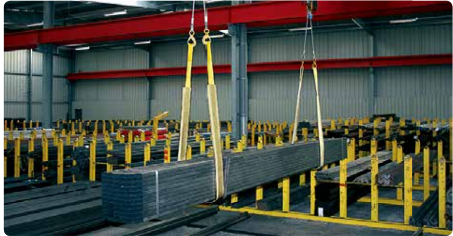
スリーブをスライドさせることで、荷物を安全に正しい位置でベルトにかけることができます。
