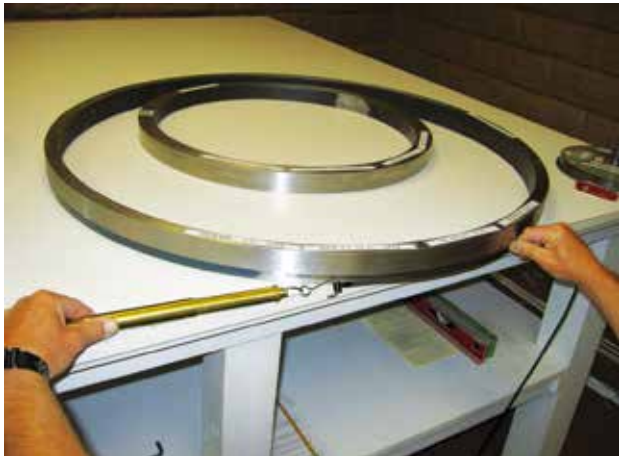
テンショナーを使って正確に外径を測定
