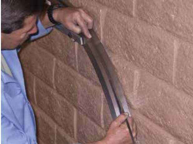
スチール製内径用パイテープでワークの内径を測定
