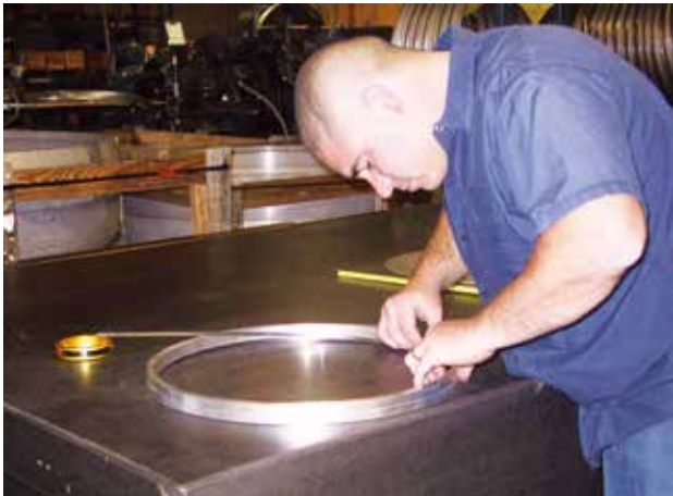
スチール製内径用パイテープでワークの内径を測定
