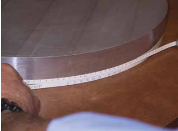
EZホワイト外径用パイテープで外径を測定
