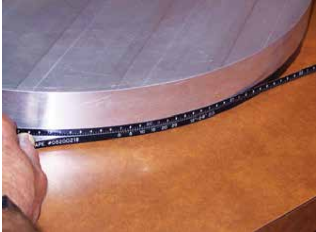
EZブルー外径用パイテープで外径を測定
