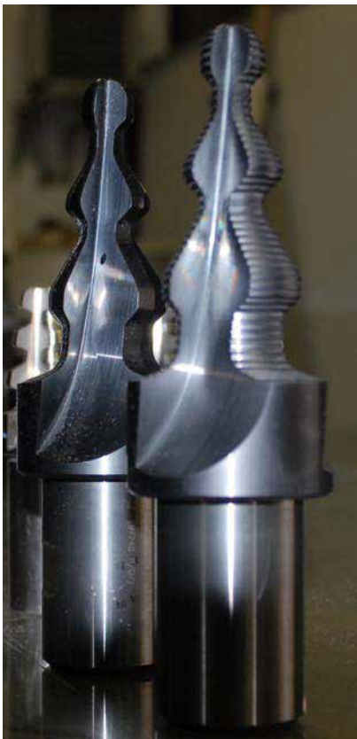
図2 ラフィングクリスマス カッターと仕上用クリスマス カッター
